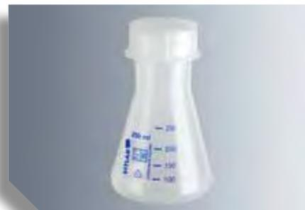
Los matraces Erlenmeyer no son instrumentos de medición. Las escalas solamente sirven como orientación.
