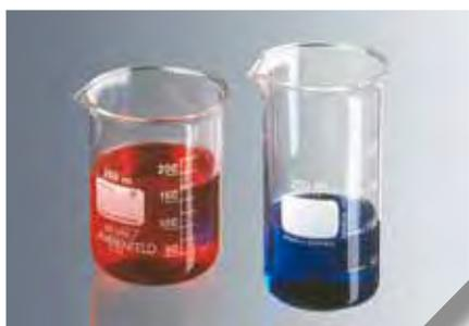
Los vasos no son instrumentos de medición. Las escalas solamente sirven como orientación.
